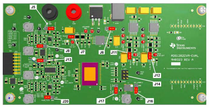
Figure 14. ADS1282-SP EVM Default Header Configuration
