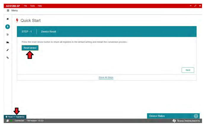
Figure 19. ADS1282-SP GUI Quick Start STEP-1
