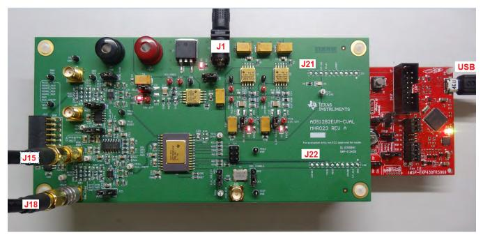
Figure 3. ADS1282-SP+MSP430 LaunchPad Hardware Setup
