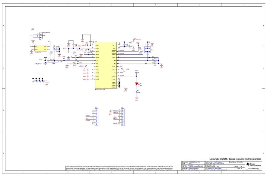
Figure 39. ADS1282-SP EVM Schematic ADC
