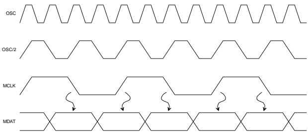
Figure 2. ADS1202 Waveform in Mode 1
