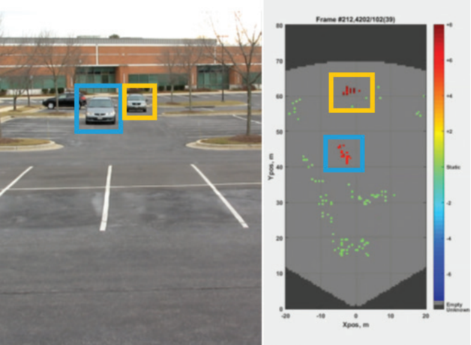
图 7. 中等距离 MIMO 示例配置检测到的两辆移动车辆。右图显示对距离大约为 40m 和 60m 的两辆车的检测，这两辆车角度不同，便于检测车道。检测点的颜色表示速度大约为每秒 6m (22 kph) 和每秒 8m (29 kph) 的车辆不同的多普勒测量结果。
