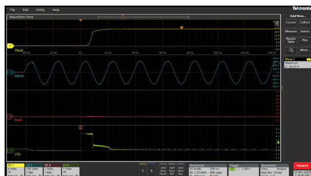
图 3-64. 24V 和 0A 下的启动响应 (过冲 = 230mV)
