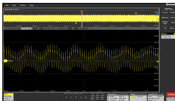
图 3-49. V_{OUT} = 9V 且满负载时的典型纹波电压 (100mVpp)
