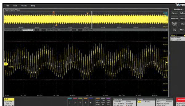
图 3-47. V_{OUT} = 12V 且满负载时的典型纹波电压 (117mVpp)
