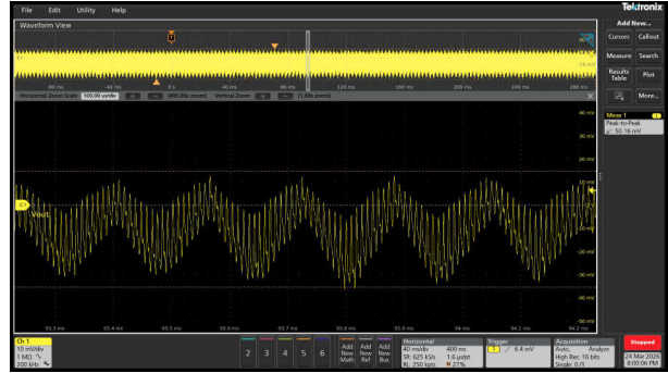
图 3-41. V_{OUT} = 24V 且满负载时的典型纹波电压 (50mVpp)
