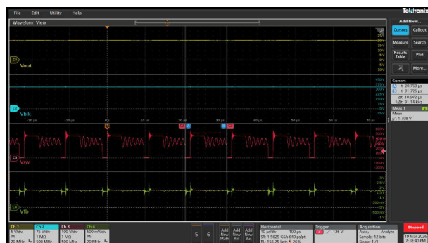
图 3-38. 230Vac/40W ( 91kHz 第 6 谷底开关/ Vfb - 1.71V )
