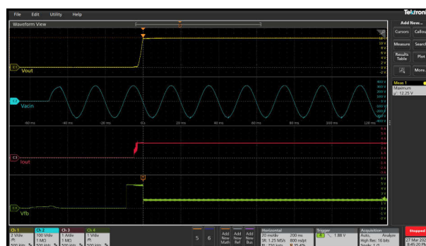
图 3-67. 12V 和 3A 下的启动响应 (过冲 = 250mV)
