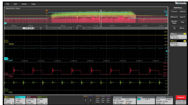
图 3-63. VIN = 90Vac ( 2 倍额定电流并持续 2ms , 0.9 倍额定电流并持续 18ms ) - 缩放版本
