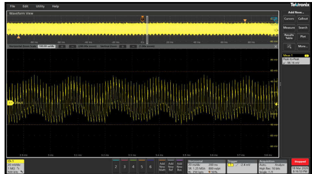
图 3-45. V_{OUT} = 15V 且满负载时的典型纹波电压 (98mVpp)
