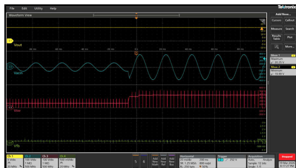
图 3-58. 20V 空载条件下从 90Vac 到 264Vac 的线路瞬态
