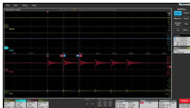
图 3-34. 230Vac/0.4W ( 25kHz 突发频率/Vfb - 0.27V )
