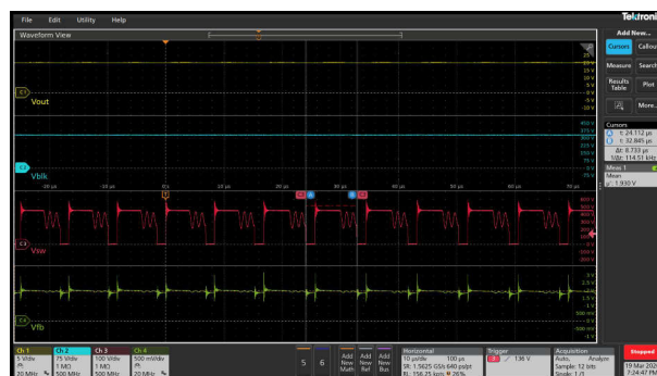
图 3-39. 230Vac/65W ( 115kHz 第 3 谷底开关/Vfb - 1.93V )
