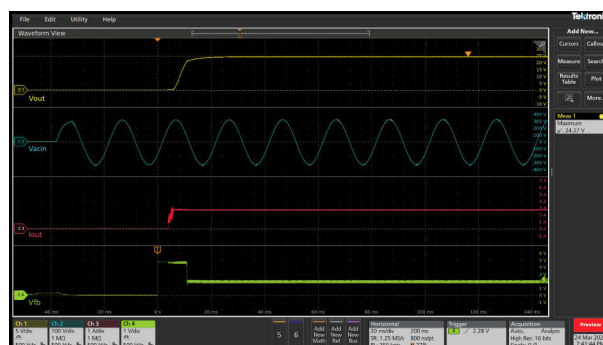
图 3-65. 24V 和 2.71A 下的启动响应 (过冲 = 270mV)
