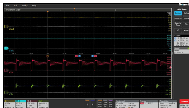
图 3-37. 230Vac/16W ( 53kHz 频率-折返/Vfb - 1.45V )
