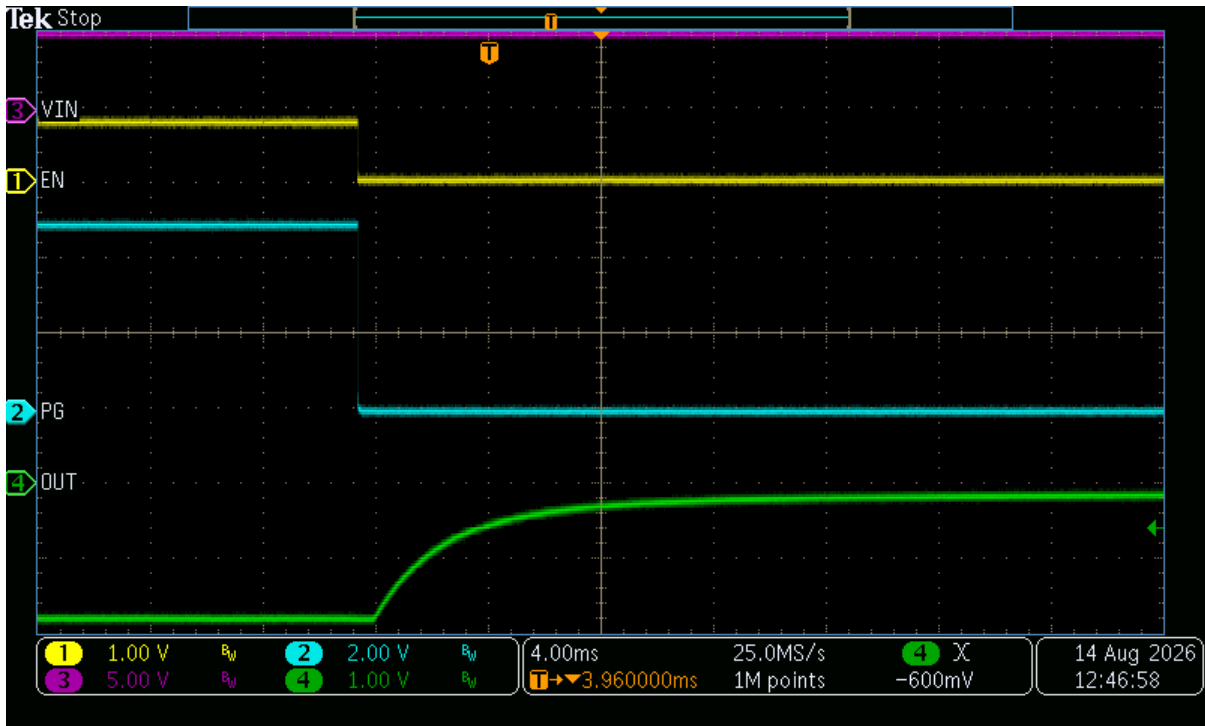
图 3-7. 电源正常置为无效 — EN 独立驱动为低电平
