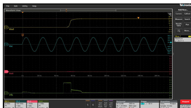
图 3-64. 24V 和 0A 下的启动响应
