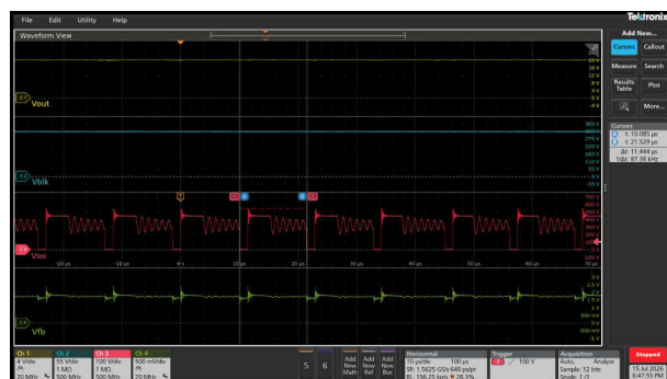
图 3-38. 230Vac/40W ( 87kHz 第 6 谷底开关/Vfb - 1.73V )
