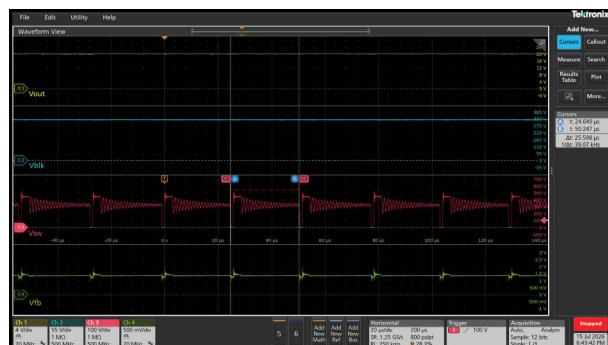
图 3-36. 230Vac/10W ( 39kHz 频率-折返/Vfb - 1.35V )
