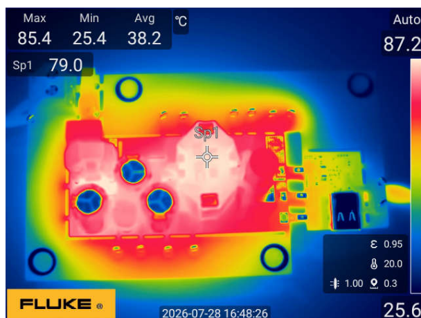
图 3-72. 顶面为 115Vac 至 24V/2.71A
