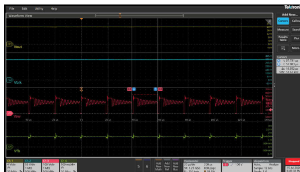
图 3-37. 230Vac/16W ( 52kHz 频率-折返/Vfb - 1.46V )
