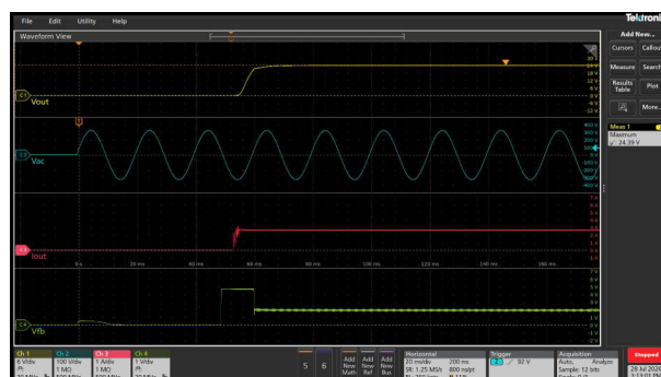
图 3-65. 24V 和 2.71A 下的启动响应
