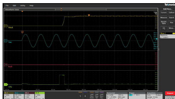
图 3-68. 5V 和 0A 下的启动响应
