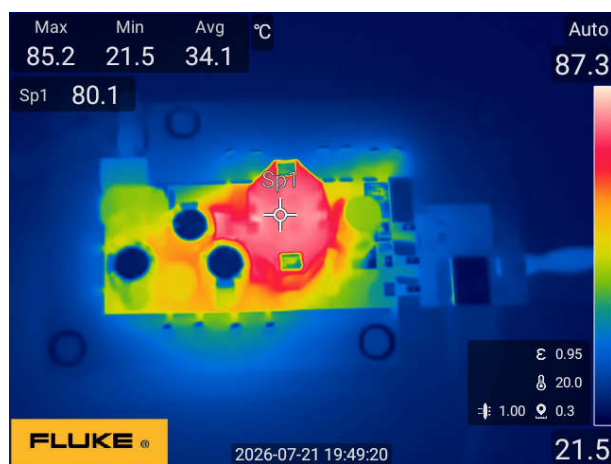
图 3-82. 顶面为 230Vac 至 20V/3.25A
