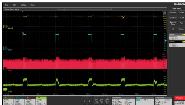
图 3-61. VIN = 90Vac ( 2 倍额定电流持续 2ms , 0.9 倍额定电流持续 18ms )
