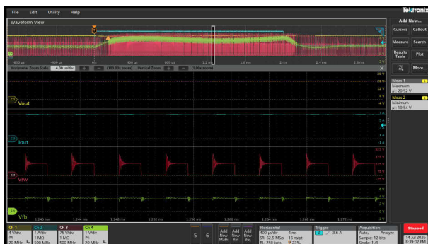
图 3-63. VIN = 90Vac ( 2 倍额定电流并持续 2ms , 0.9 倍额定电流并持续 18ms ) - 缩放版本
