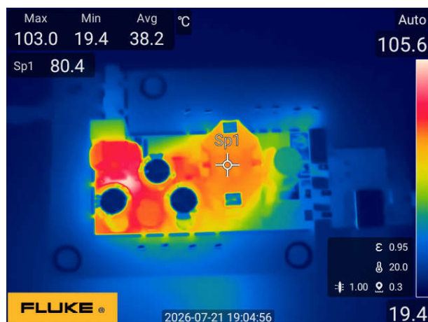
图 3-78. 顶面为 90Vac 至 20V/3.25A
