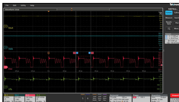
图 3-39. 230Vac/65W ( 106kHz 第 3 谷底开关/Vfb - 1.93V )
