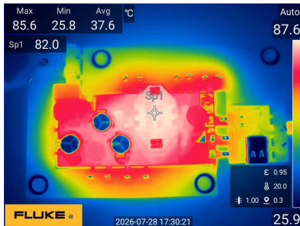
图 3-74. 顶面为 230Vac 至 24V/2.71A
