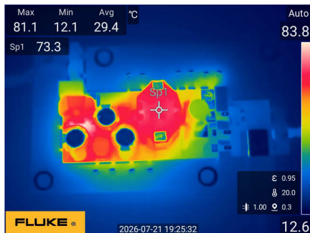
图 3-80. 顶面为 115Vac 至 20V/3.25A
