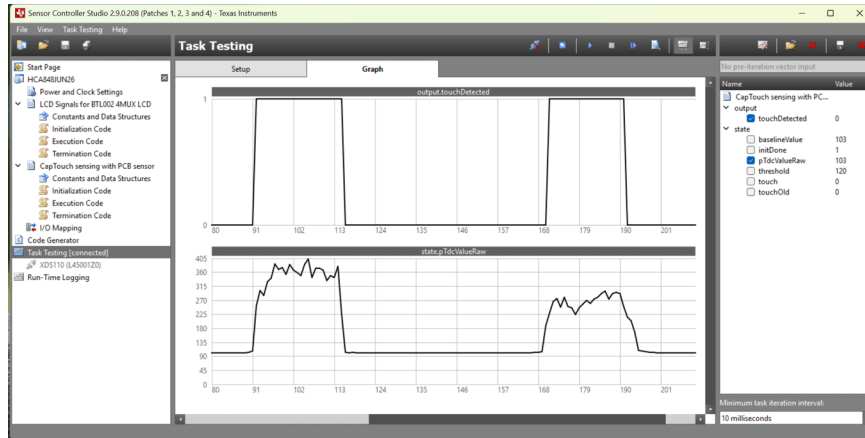
图 7-1. SCS 下的任务测试：触摸事件即上方两个图形中的峰值
