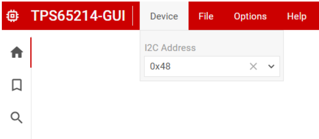
图 4-2. 设置 GUI 中的 I2C 地址
