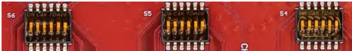
图 2-16. 电阻分压器网络开关
