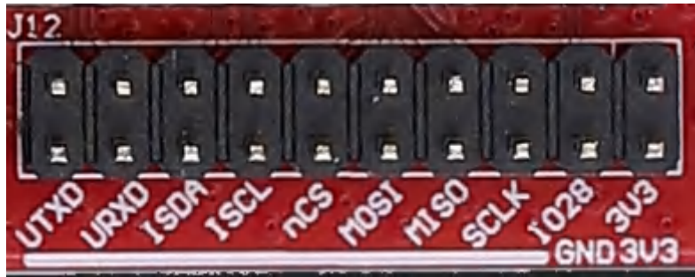
图 2-6. 用于无线 MCU 接口的 J12 排针
