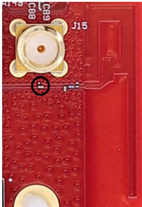
图 2-24. 用于辐射或传导测试的电容器
