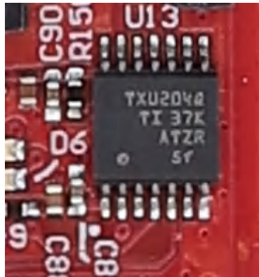
图 2-19. U3 TXU0204-Q1 电平转换器
