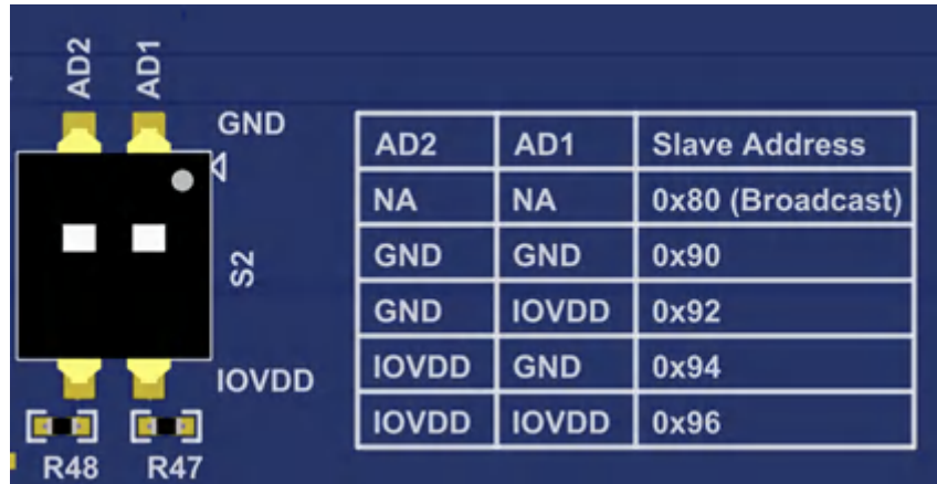
图 2-7. 用于 I 2 C 地址选择的 DIP 开关 S2-S3
