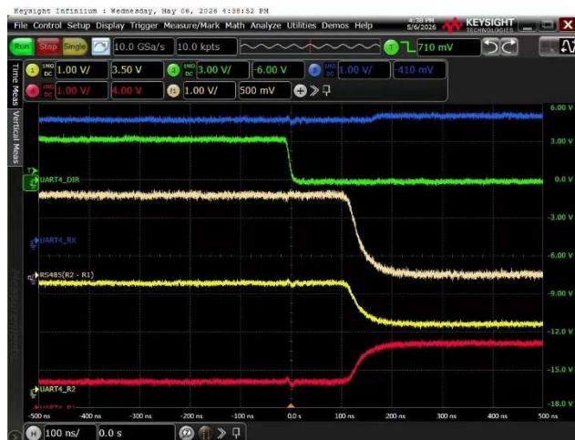
图 4-2. 测试结果：增加总线电容器后无毛刺
