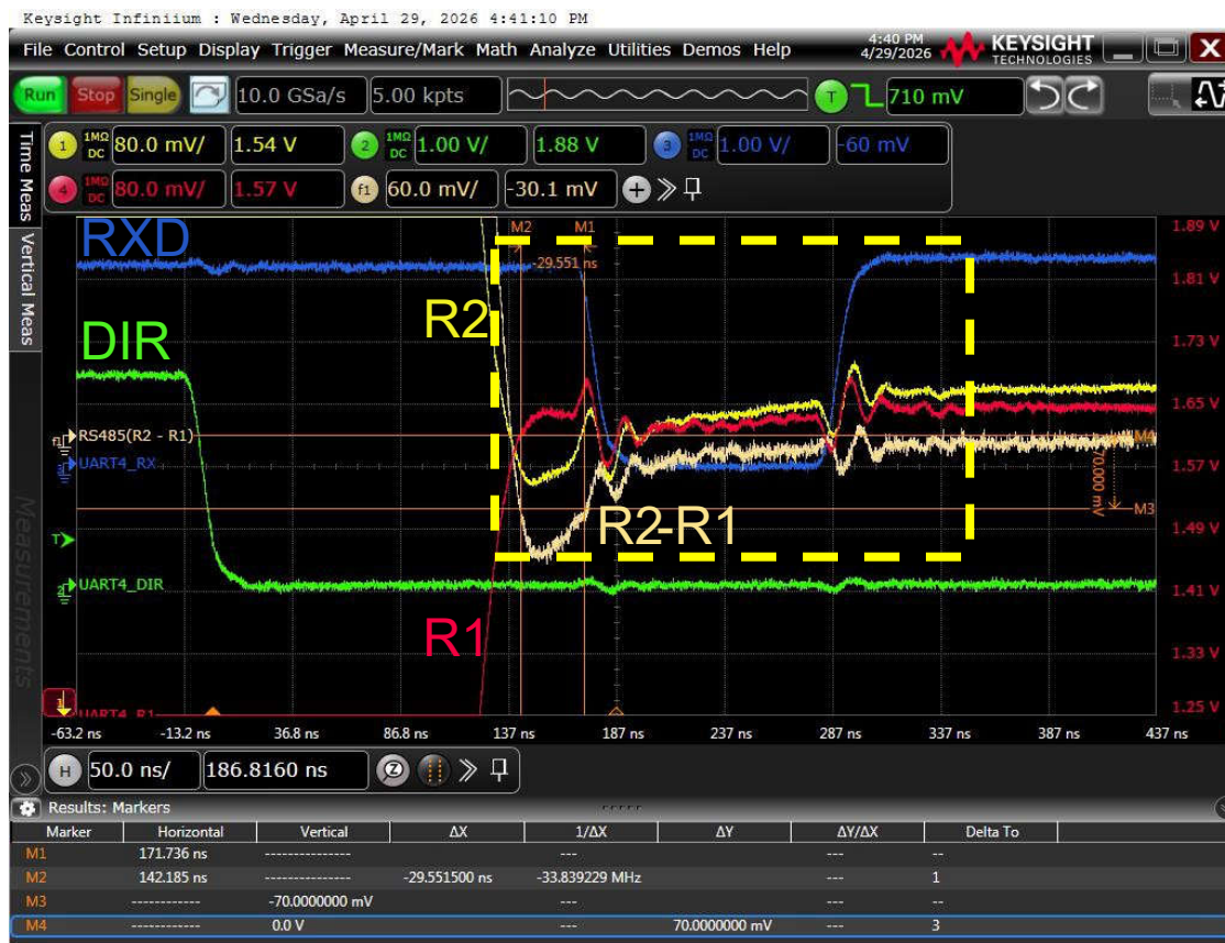
图 3-2. 实际的 RXD 毛刺 (约 100ns)
