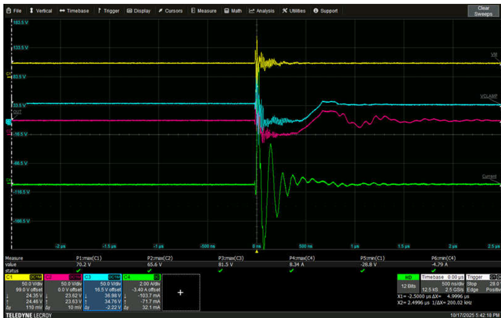
图 14. OUT 线路上 2.5kV 时的 EFT — 放大视图
