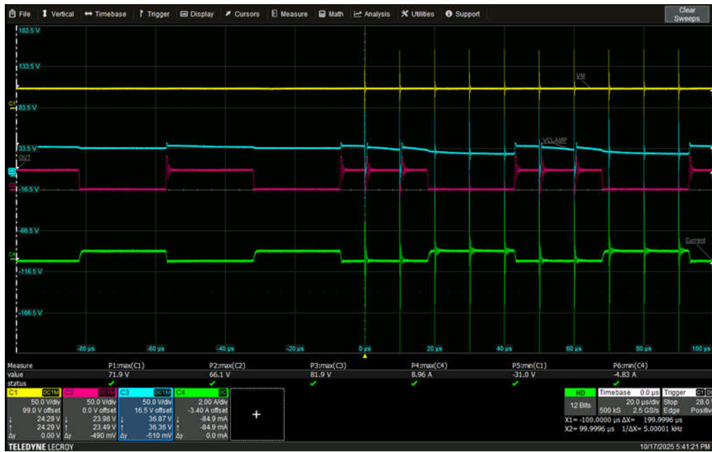
图 13. OUT 线路上 2.5kV 时的 EFT
