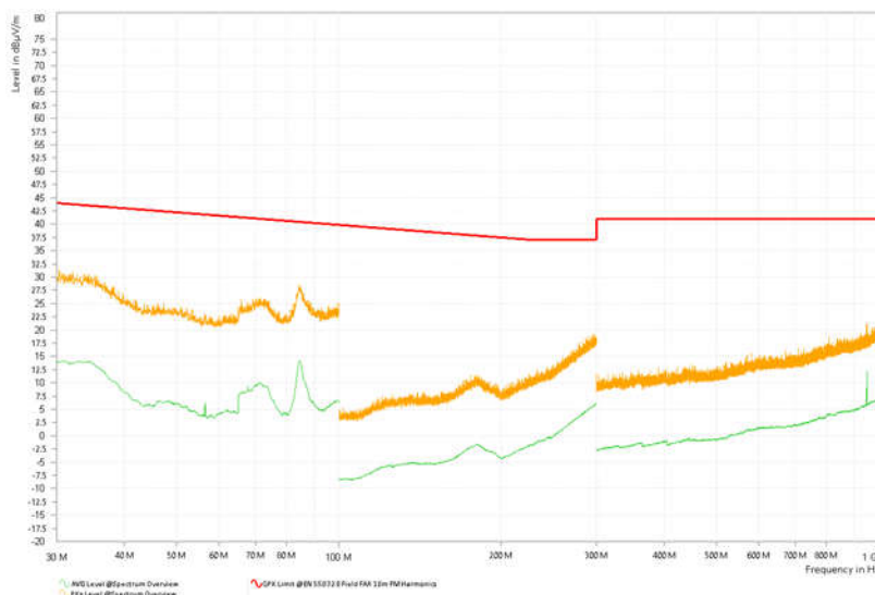
图 22. 辐射发射 — 待机状态， V_M = 12V ， I_{N_x} = 5V ，无负载
