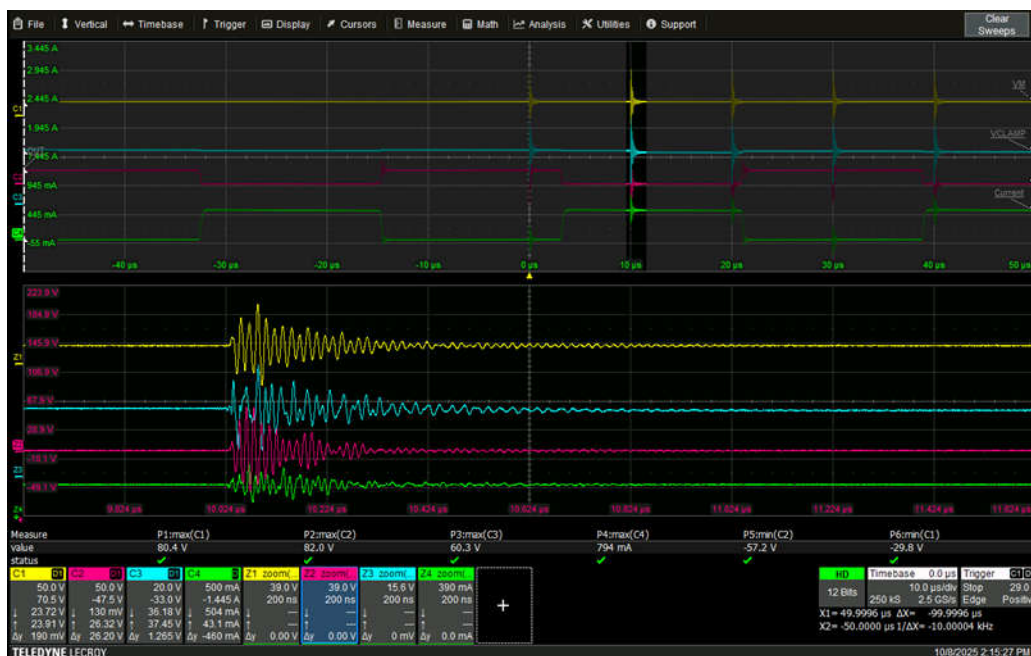
图 11. 1500V 时驱动器关断状态下捕获的浪涌波形（局部放大图）
