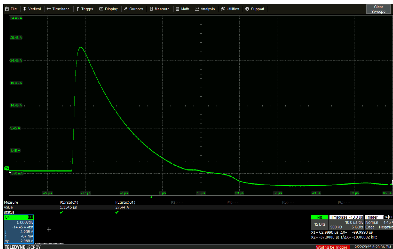
图 5. 1200V 时捕获的浪涌波形
