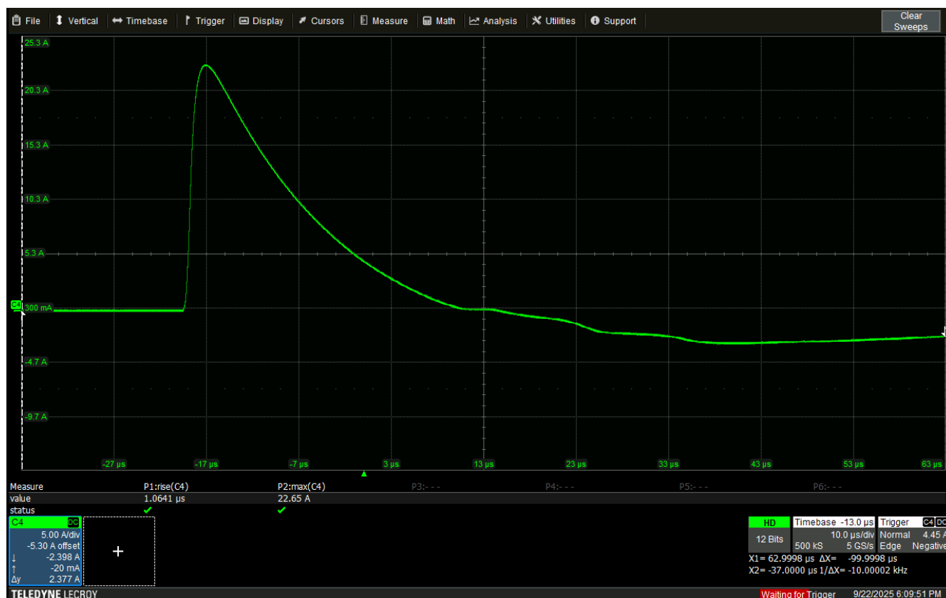
图 4. 1000V 时捕获的浪涌波形
