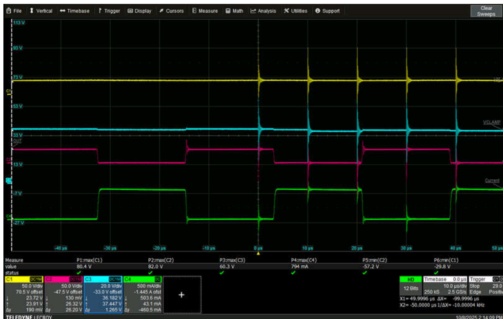
图 10. 1500V 时驱动器导通状态下捕获的浪涌波形
