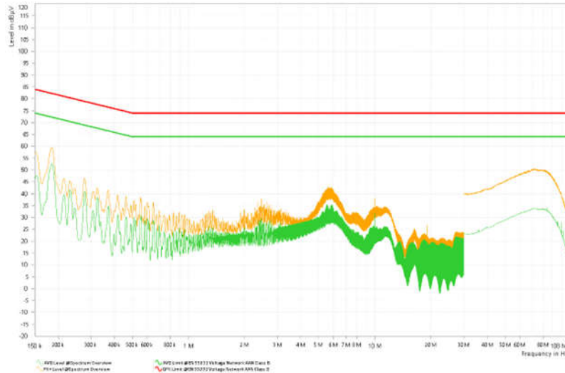
图 19. 传导发射 — 工作状态，施加 PWM 信号， V_M = 12V ， I_{N_x} = 3.3V (20kHz 时)， 48\Omega 负载
