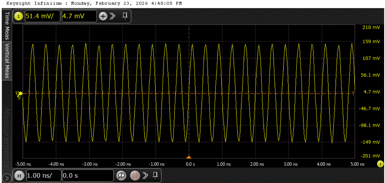
图 4-2. CP1 合规码型 - 示波器波形
