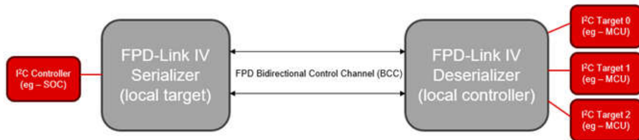
图 3-1. 时钟延展中的 I2C 卡滞问题示例
