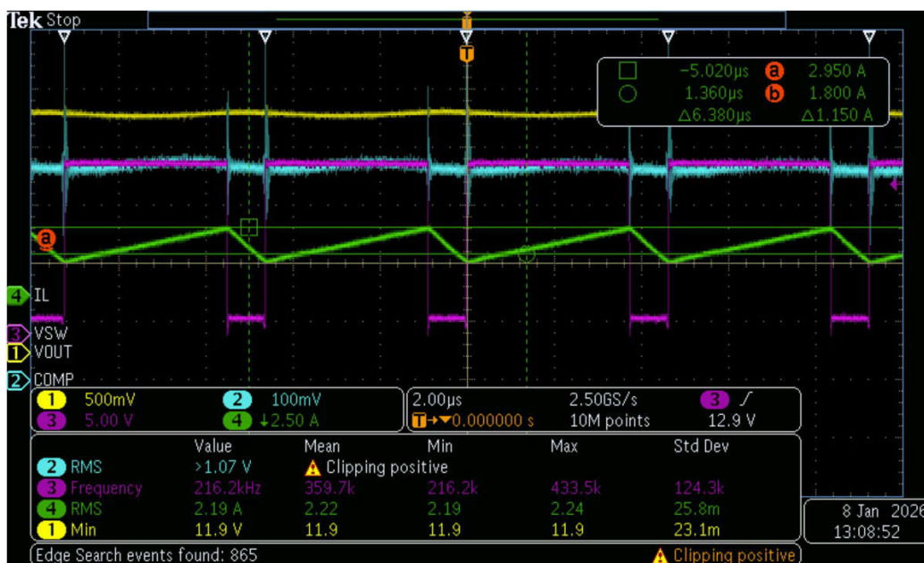
图 3-2. LM5190 负载电流为 2.224A 时的实验结果
