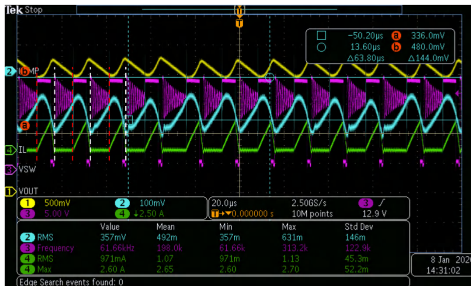
图 5-1. LM5190 负载电流为 0.589A 时的实验结果
