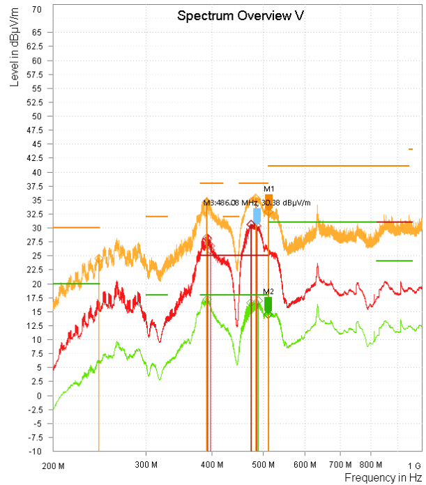
图 3-4. TPSM33620-Q1 不带缓冲器、垂直极化、12VIN、3.3VOUT、2A 时的辐射 EMI
