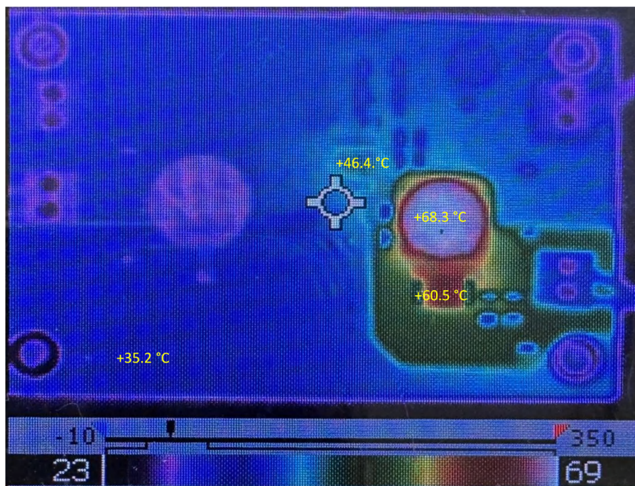
图 3-8. EVM 热像图， V_{IN} = 48V ， I_{OUT} = I_{OUT\_ISO} = 0.500A 。 T_A = 25^\circ C ，无气流
