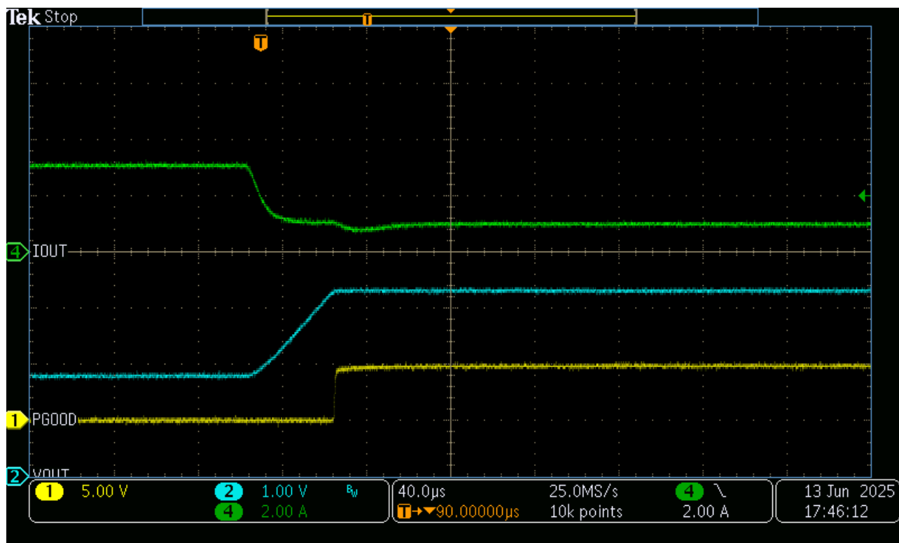
图 3-4. 电流限制释放 - 0.55\ \Omega 至 3.3\ \Omega 阶跃
