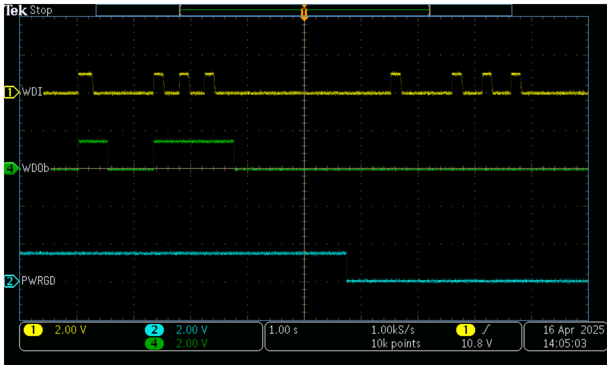
图 3-11. 当 PWRGD 指示通道 1/2 不再处于调节状态时，WD_TMR = 56.2kOhms
