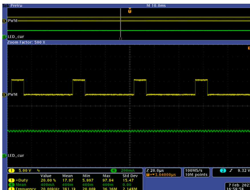
图 5-12. 20% 占空比、20kHz 混合调光时的波形
