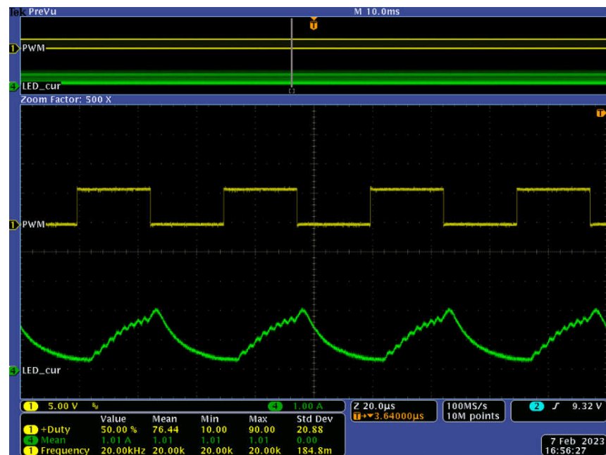
图 5-8. 50% 占空比、20kHz PWM 调光时的波形
