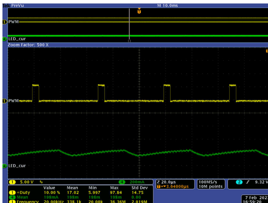
图 5-11. 10% 占空比、20kHz 混合调光时的波形
