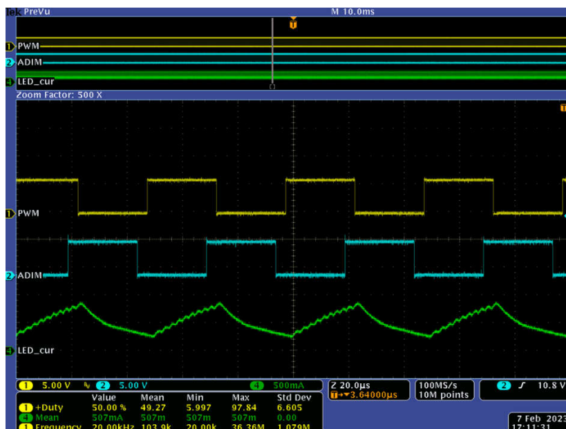
图 5-14. 50% 占空比 ADIM/HD 和 50% 占空比 PWM/EN 时的波形
