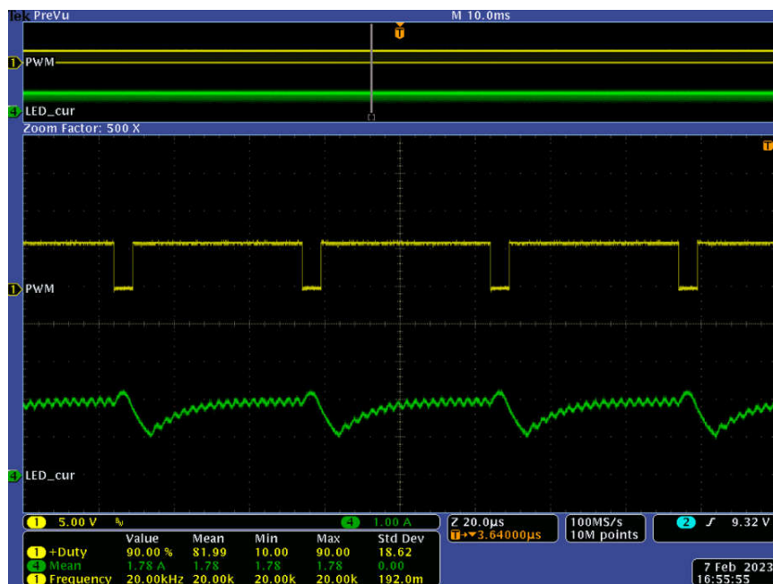
图 5-9. 90% 占空比、20kHz PWM 调光时的波形
