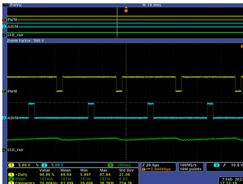
图 5-15. 10% 占空比 ADIM/HD 和 90% 占空比 PWM/EN 时的波形
