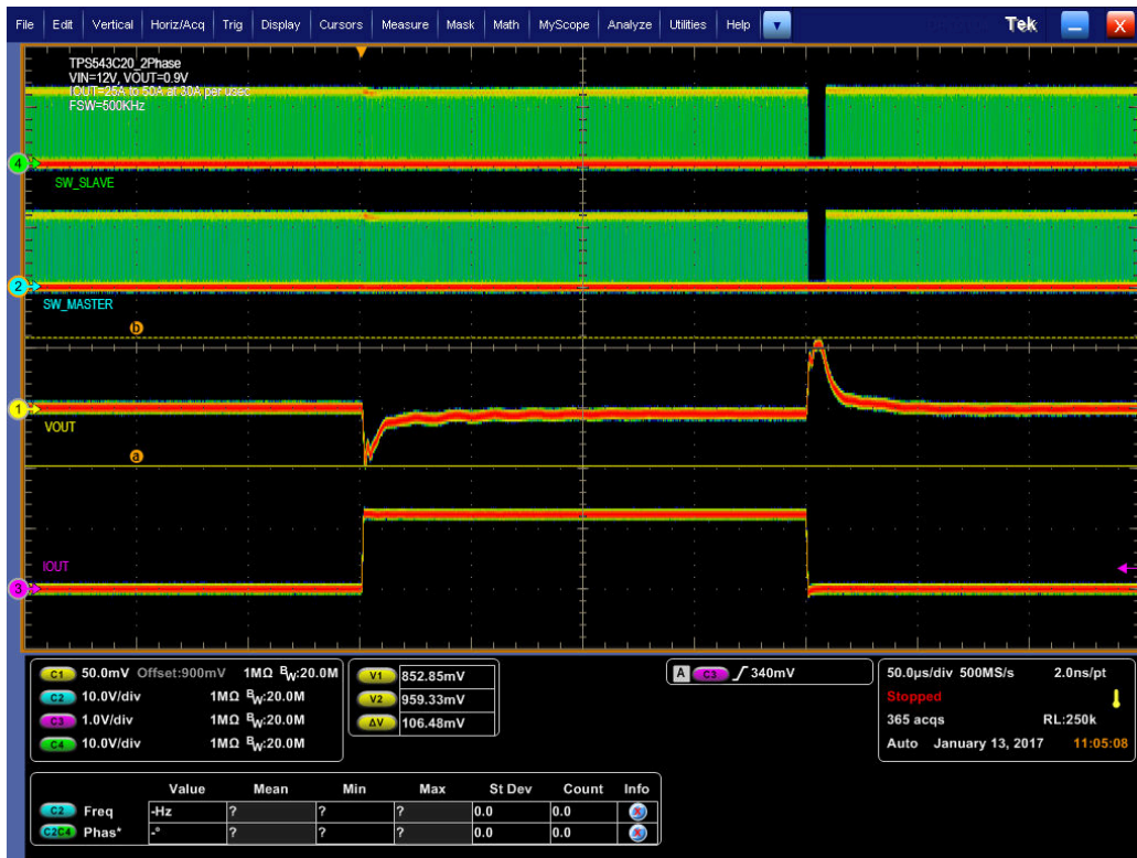
图 9-4. 在 0.9V 输出下且 V IN 为 12 时的瞬态响应，瞬态是 25A 至 50A，30A/μs 下的阶跃为 25A
