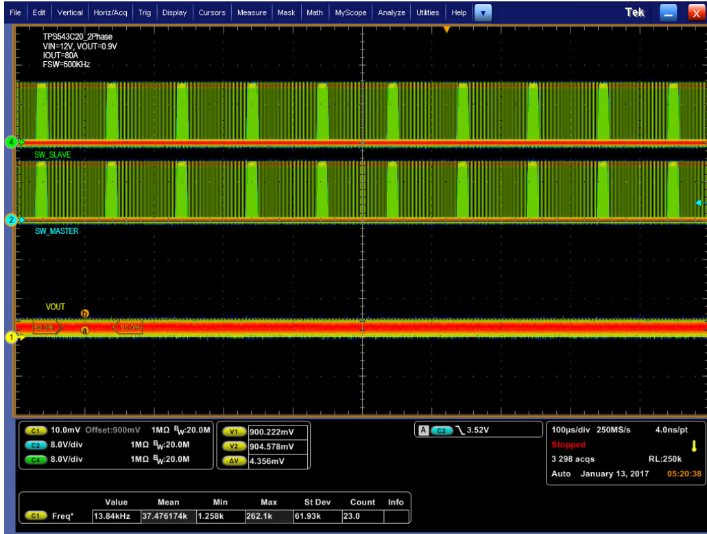
图 9-7. 在 0.9V 输出下且 V_{IN} 为 12、输出为 80A 时的输出纹波和开关节点
