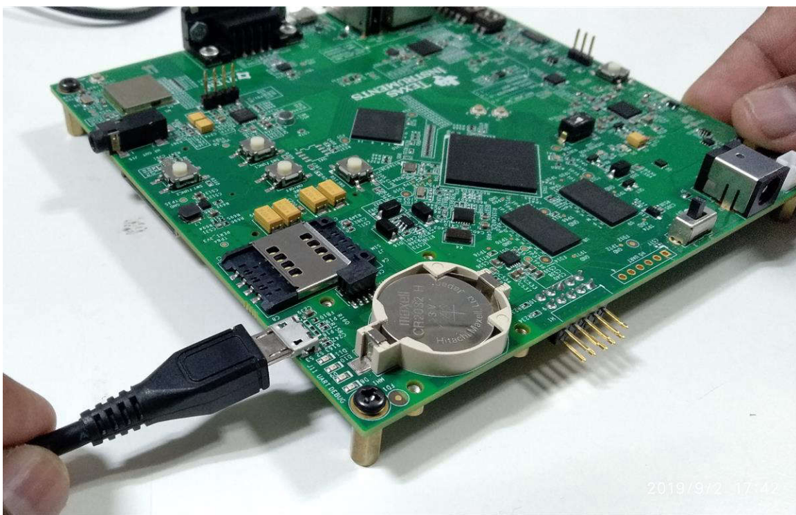
图 3-6. 将 micro-B 电缆插入 J11
