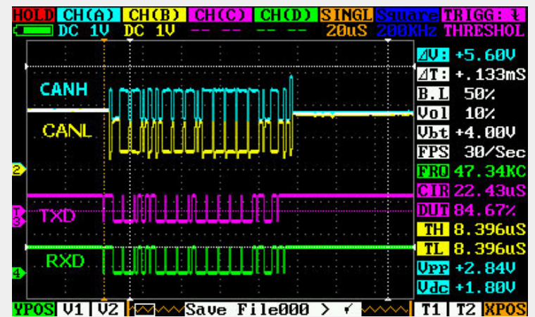
图9 TI CAN演示系统的信号
