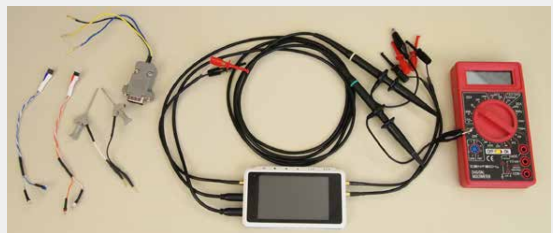
图1 CAN物理层调试基本工具
