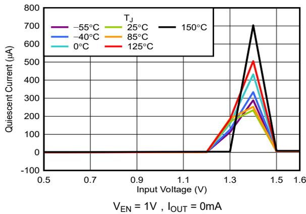
图 5-9.  $I_{GND}$  与  $V_{IN}$  间的关系
