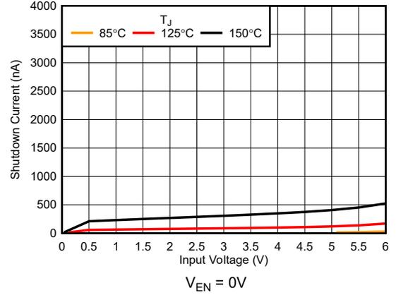
图 5-14. 关断电流与  $V_{IN}$  间的关系
