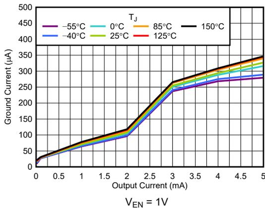
图 5-11.  $I_{GND}$  与  $I_{OUT}$  间的关系
