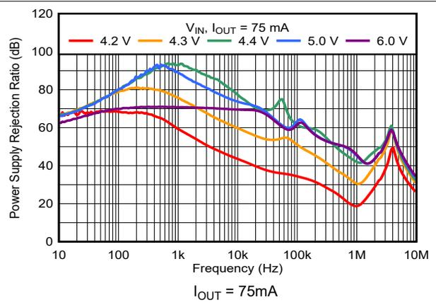
图 5-26. PSRR 与频率和  $V_{IN}$  间的关系
