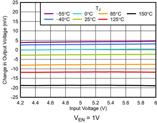
图 5-1. 线性调整率与  $V_{IN}$  间的关系
