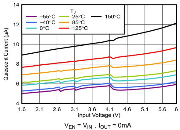
图 5-10.  $I_{GND}$  与  $V_{IN}$  间的关系
