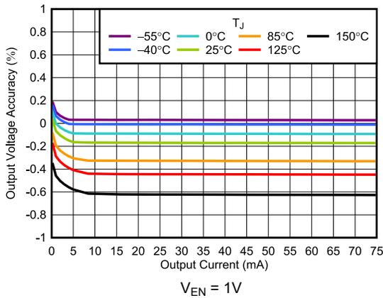
图 5-5. 输出电压精度与  $I_{OUT}$  间的关系
