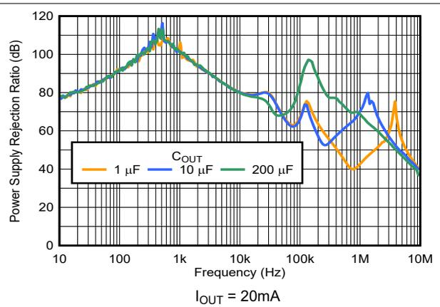
图 5-28. PSRR 与频率和  $C_{OUT}$  间的关系
