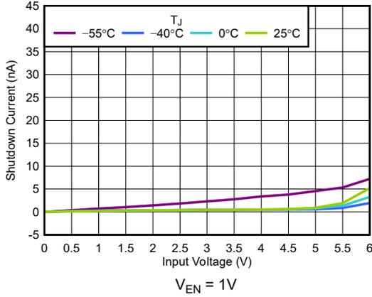
图 5-13. 关断电流与  $V_{IN}$  间的关系
