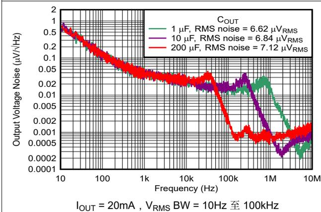
图 5-33. 噪声与频率和  $C_{OUT}$  间的关系
