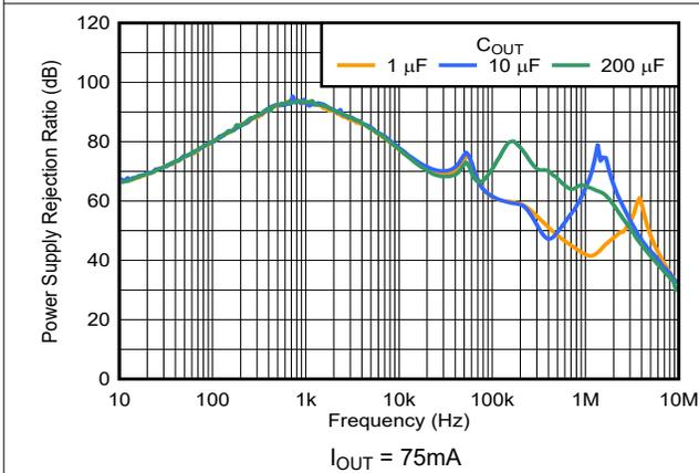
图 5-29. PSRR 与频率和  $C_{OUT}$  间的关系
