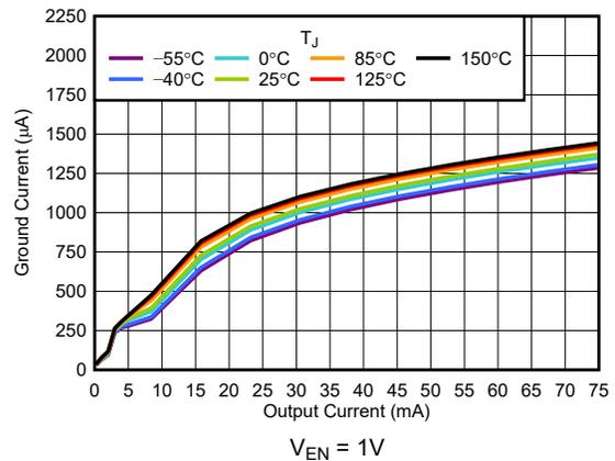
图 5-12.  $I_{GND}$  与  $I_{OUT}$  间的关系
