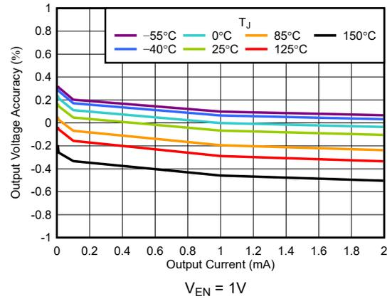
图 5-4. 输出电压精度与  $I_{OUT}$  间的关系
