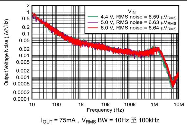
图 5-32. 噪声与频率和  $V_{IN}$  间的关系
