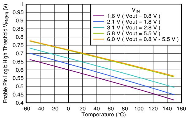
图 5-17. 使能逻辑高电平阈值与温度间的关系
