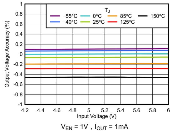
图 5-6. 输出电压精度与  $V_{IN}$  间的关系
