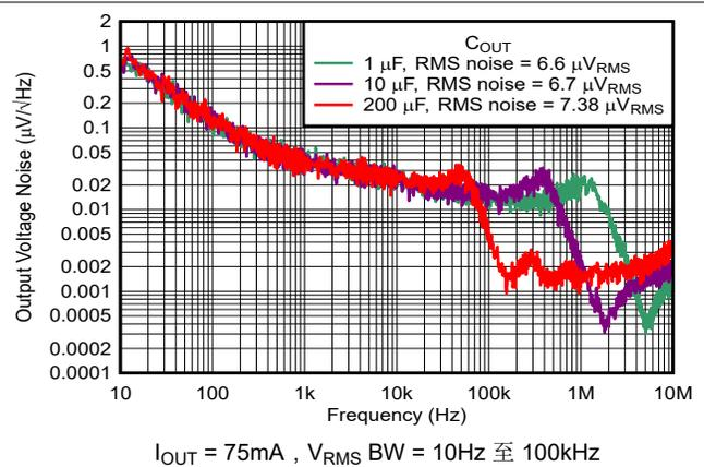
图 5-34. 噪声与频率和  $C_{OUT}$  间的关系
