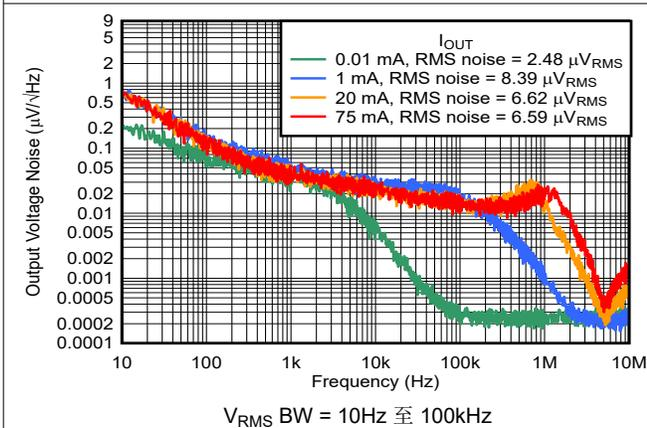
图 5-35. 噪声与频率和  $I_{OUT}$  间的关系
