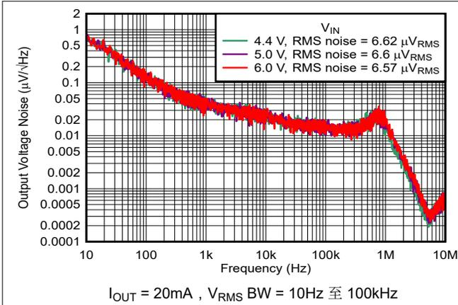
图 5-31. 噪声与频率和  $V_{IN}$  间的关系
