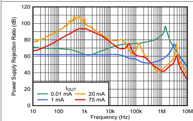
图 5-27. PSRR 与频率和  $I_{OUT}$  间的关系
