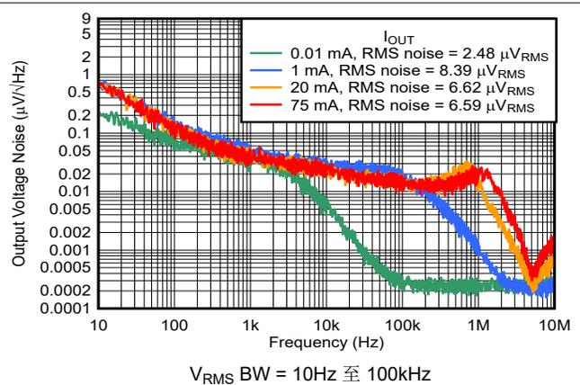
图 5-30. 噪声与频率和  $I_{OUT}$  间的关系
