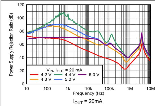
图 5-25. PSRR 与频率和  $V_{IN}$  间的关系
