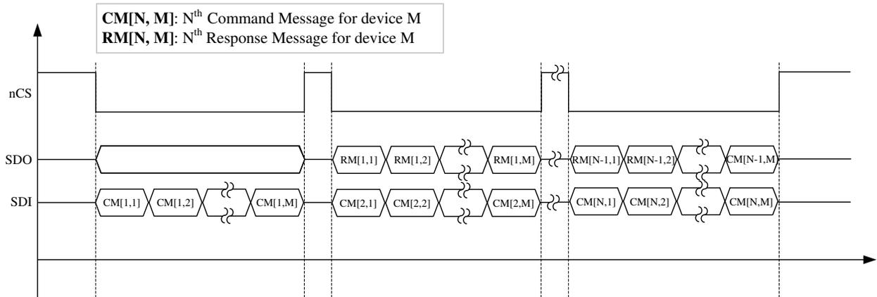
图 7-41. SPI message frame daisy chain SPI configuration
