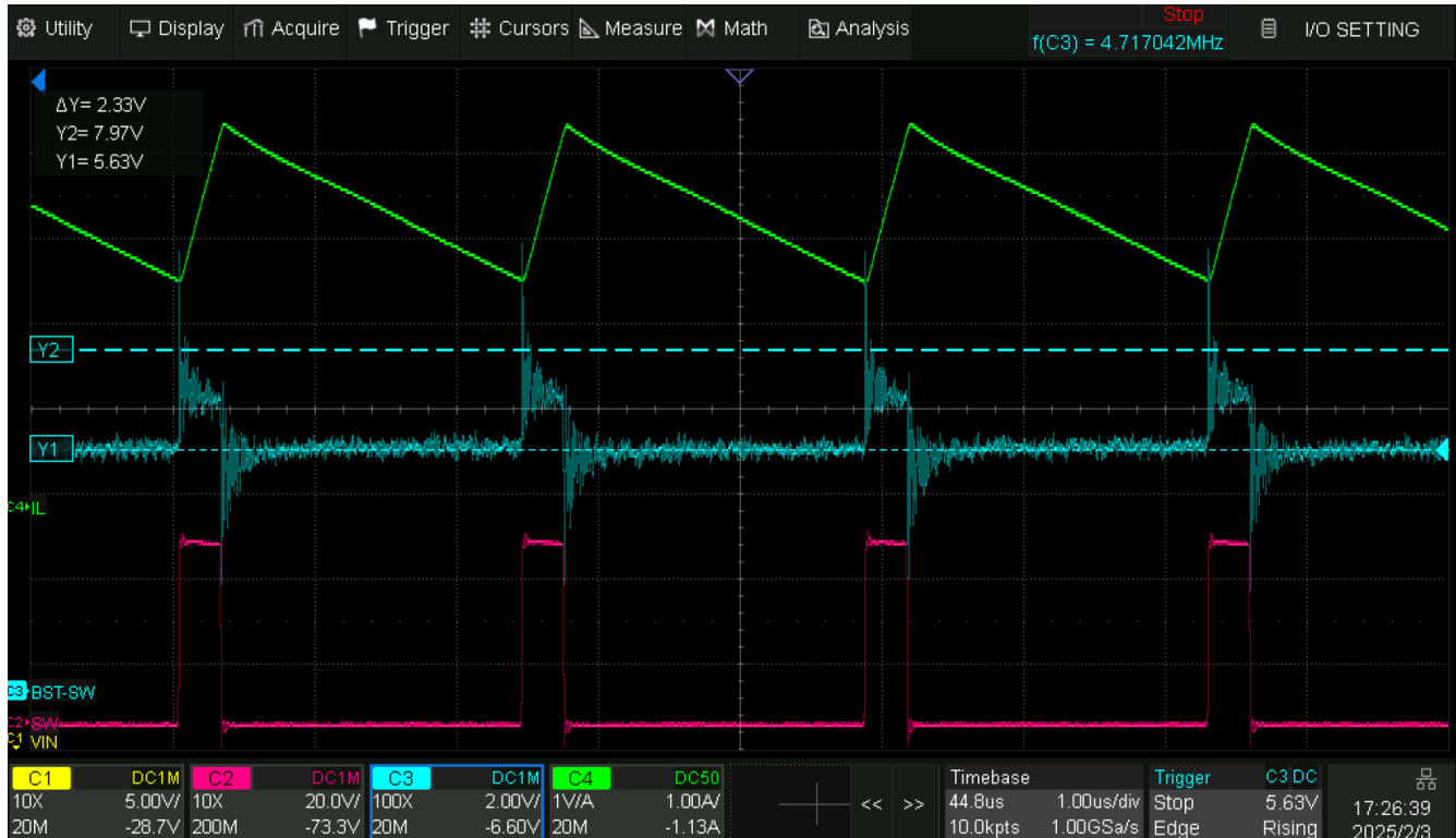
图 4-1. 45Vin、5Vout、3.5A 负载下 BOOT-SW 正常行为波形
