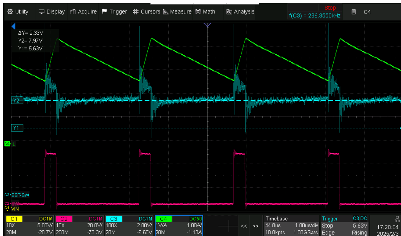
图 4-2. 45Vin、5Vout、3.5A 负载下 BOOT-SW 升至 8V 的波形
