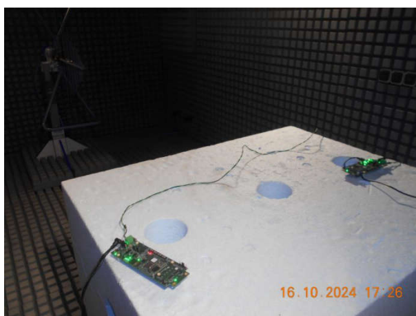
图 5-3. 采用单线对以太网的两块 TIDA-010261 进行连接
