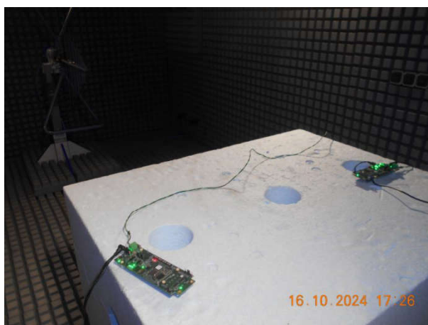
图 6-21. TIDA-010261 非屏蔽单线对双绞线辐射发射测试设置
