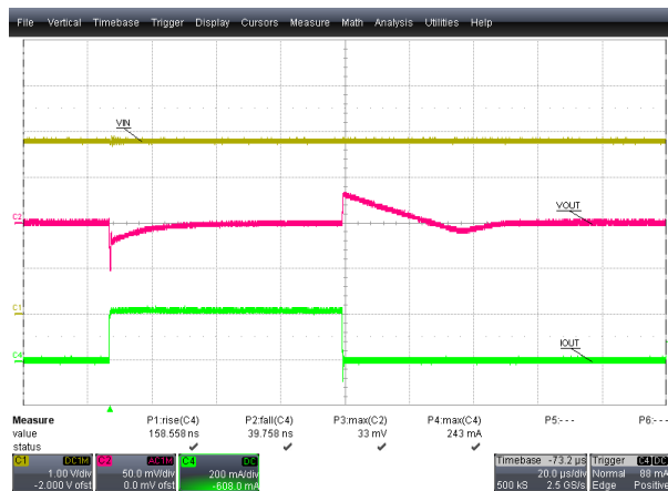
图 3-12. 使用短布线的电流探头测量
