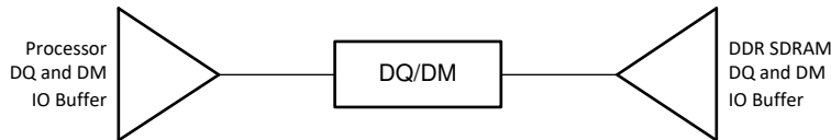
图 2-10. DDR4 DQ/DM 拓扑
