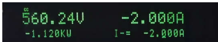
图 5-19. PFC 硬件在 130V 交流输入下的输出总线电压
