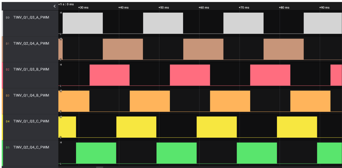
图 5-1. 实验 1 EPWM 输出波形
