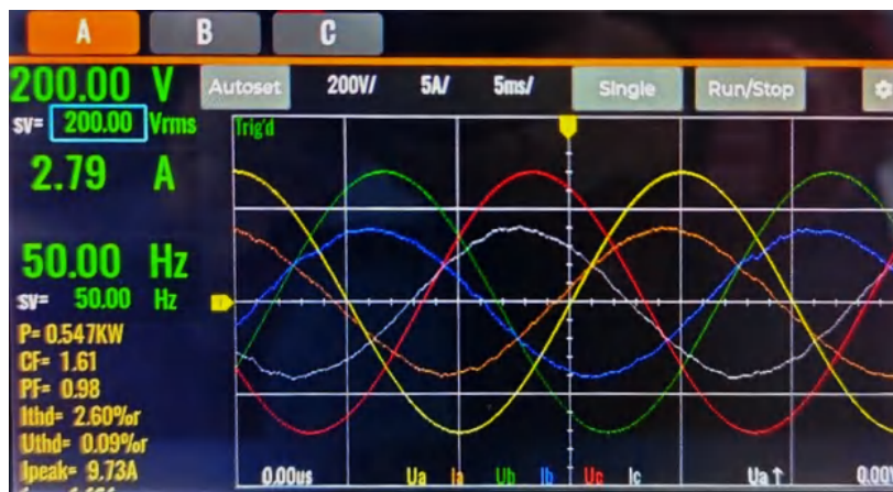
图 5-16. PFC 模式下 TIDA 硬件电网侧 200V 交流输入的 I_a 、 I_b 、 I_c 波形
