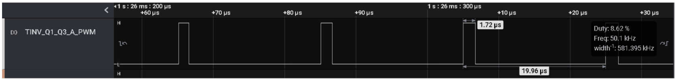
图 3-10. CMPA 值可改变 EPWM0 波形的占空比
