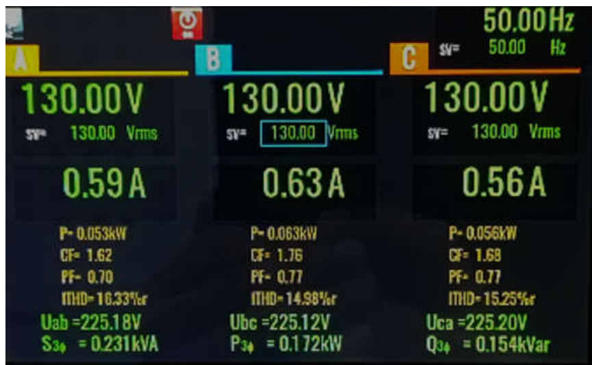
图 5-21. 130V 交流输入和恒定总线电压基准值下的 ITHD 和 PF 值
