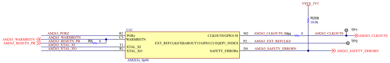
图 3-3. AM263x LaunchPad 布局摘录 - CLKOUT0 和 EXT_REFCLK0 输出
