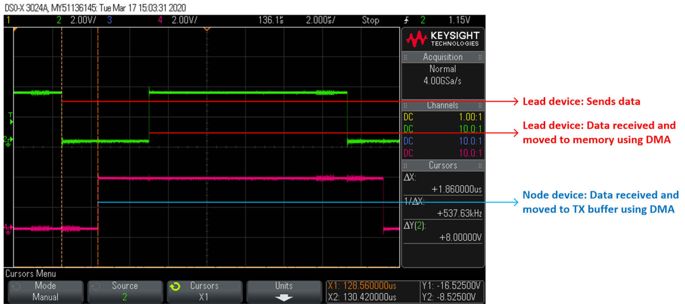
图 5-4. 使用 DMA 控件的 FSI 通信
