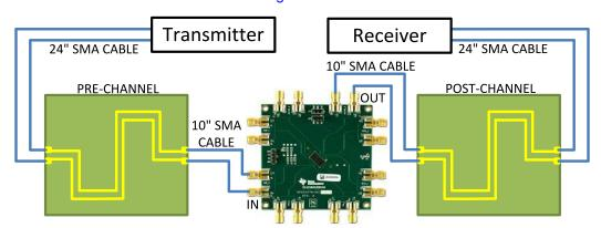
Figure 1. Test Setup with DS125BR820EVM
