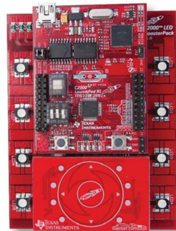
▲ 利用专注于应用并直接插入接头的 C2000 BoosterPacks 扩展您的 C2000 Piccolo LaunchPad。
