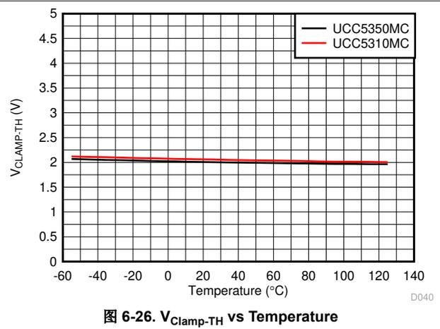
图 6-26.  $V_{Clamp-TH}$  vs Temperature
