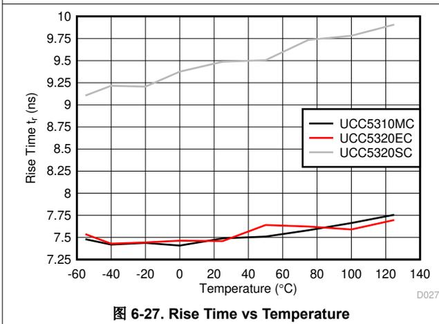
图 6-27. Rise Time vs Temperature
