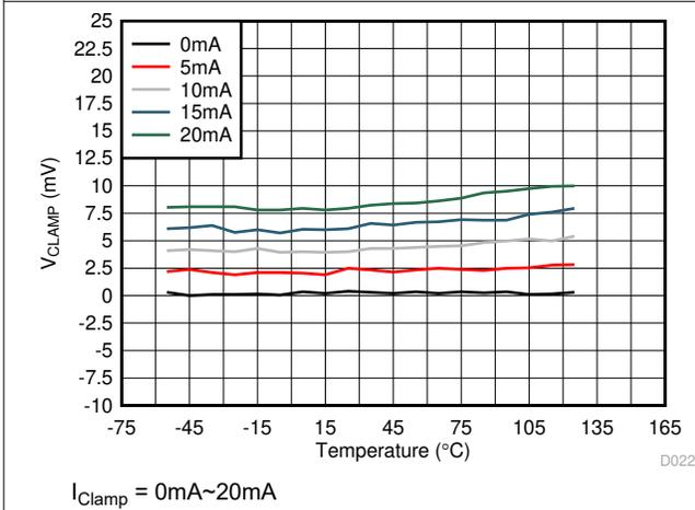
图 6-25. UCC5350M  $V_{Clamp}$  vs Temperature
