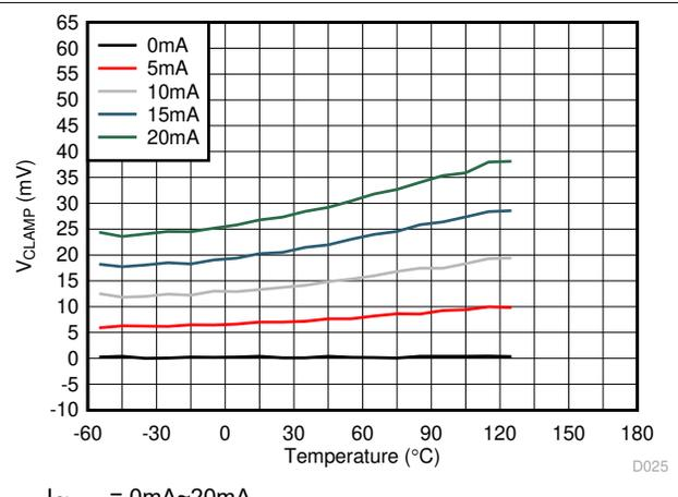
图 6-24. UCC5310M  $V_{Clamp}$  vs Temperature
