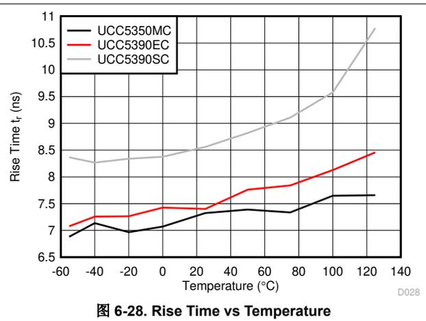
图 6-28. Rise Time vs Temperature
