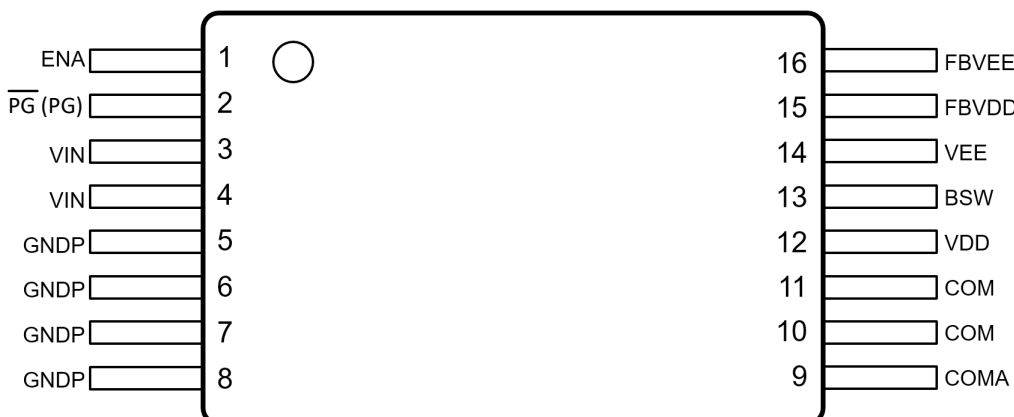
图 5-1. DHA 封装，16 引脚 SSOP (俯视图)
