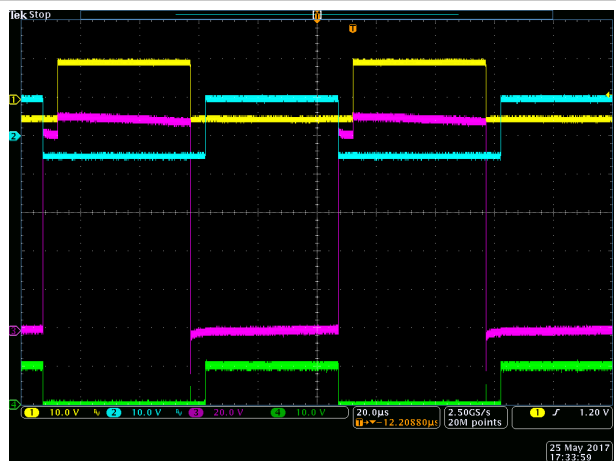
A. V_{DD} = 10\text{ V} V_{in} = 100\text{ V} C_L = 1\text{ nF} Ch1 = HI Ch2 = LI Ch3 = HO Ch4 = LO
