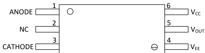
图 5-1. UCC23313-Q1 Package SO-6 Top View
