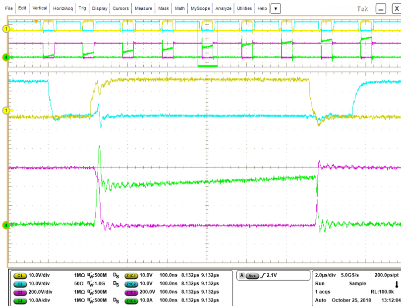
图 8-6. SiC MOSFET 开关波形
