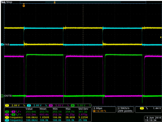
图 8-5. INA/B 和 OUTA/B 的台架测试波形
