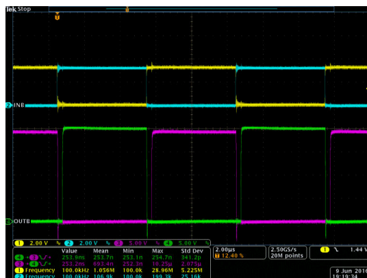
图 8-5. INA/B 和 OUTA/B 的台架测试波形
