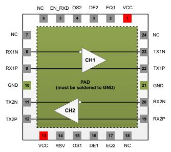
图 5-1. RGE Package, 24-Pin (VQFN) (Top View)
