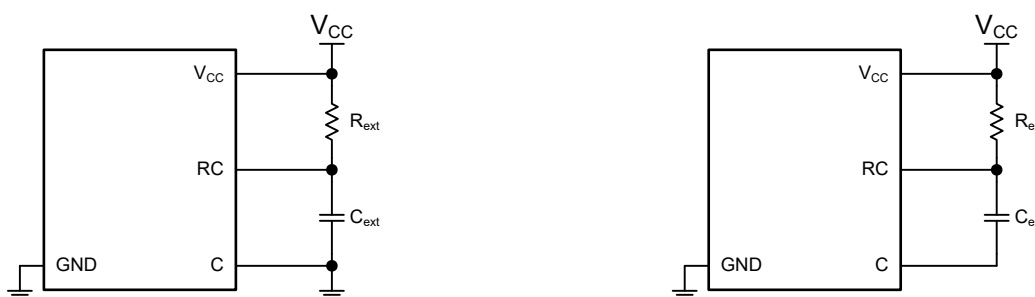
图 7-1. 时序元件连接（带和不带外部接地）
