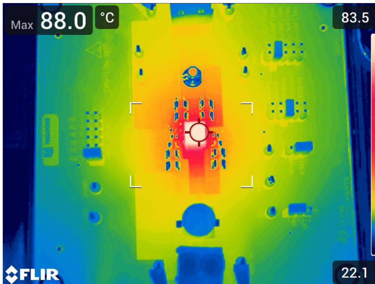
图 8-18. 25^{\circ}\text{C} 环境温度下的热图像
