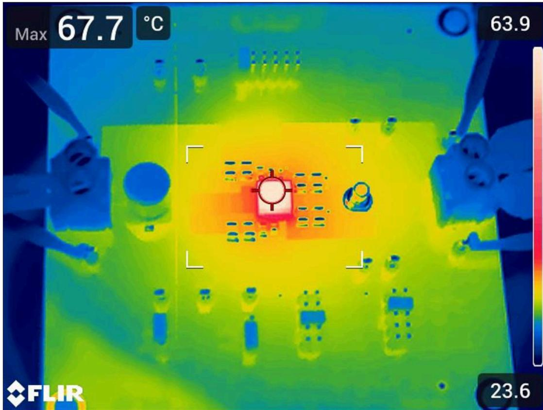
图 8-17.  $25^{\circ}\text{C}$  环境温度下的热图像
