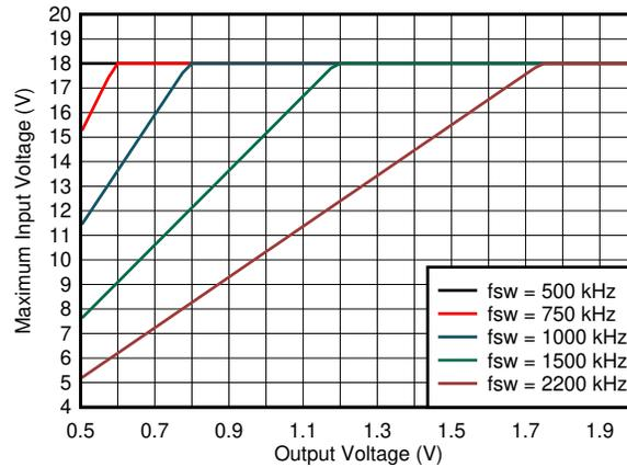
图 8-2. 最大输入电压与输出电压间的关系
