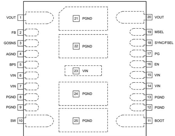
图 5-2. 25 引脚 B3QFN-RDG 封装 (顶视图)
