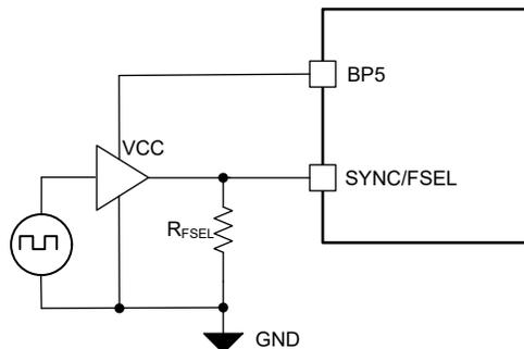
图 7-4. 将 SYNC/FSEL 引脚与缓冲器连接
