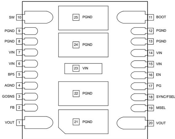
图 5-1. 25 引脚 B3QFN-RDG 封装 (底视图)
