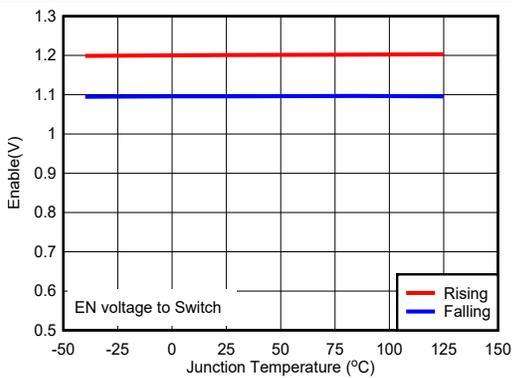
图 5-5. Enable Voltage
