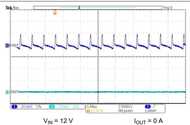
图 7-15. Output Ripple - No Load
