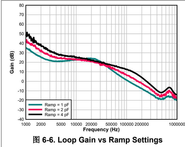
图 6-6. Loop Gain vs Ramp Settings
