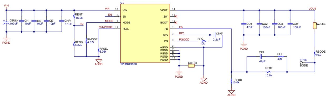
图 7-1. 12-V Input, 1.0-V Output, 1.5-MHz Schematic
