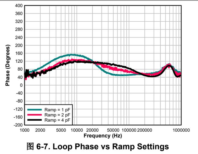
图 6-7. Loop Phase vs Ramp Settings
