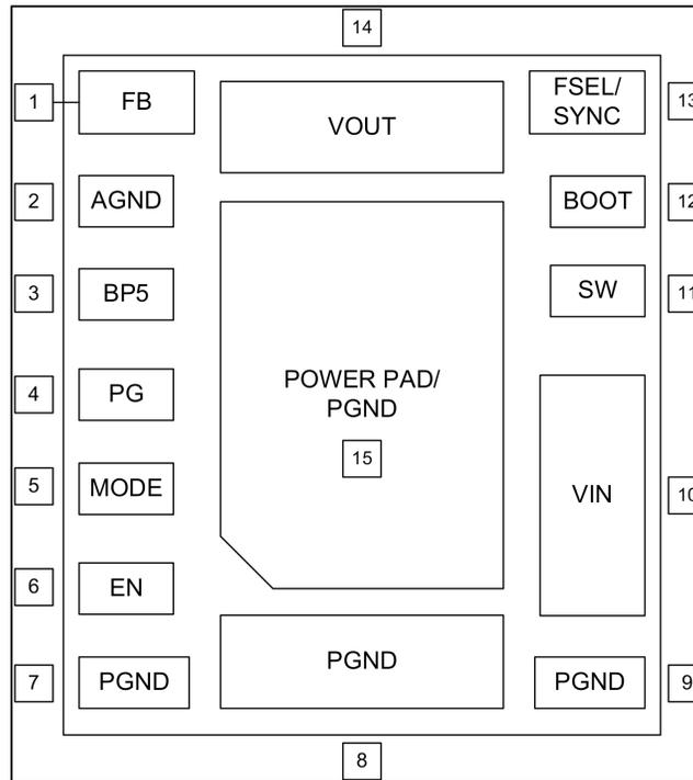
图 4-1. SIT Package 15-Pin uSiP (Top View)
