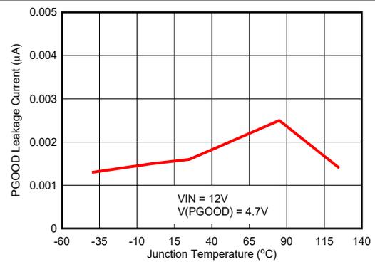
图 5-10. PG Leakage
