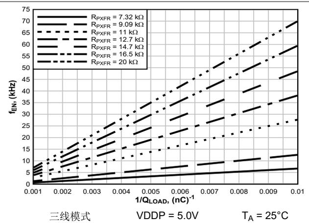
图 6-13. 最大  $f_{EN}$  与  $Q_{LOAD} = 100\text{nC}$  至  $1000\text{nC}$  间的关系
