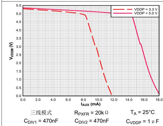
图 6-14.  $V_{VDDM}$  与  $I_{AUX}$  间的关系
