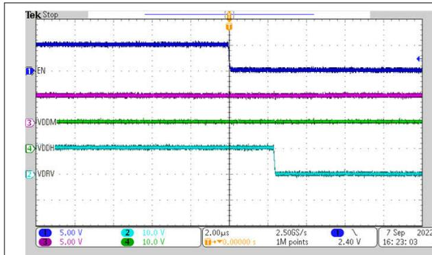
三线模式       $V_{DDP} = 5.0V$        $R_{PXFR} = 12.7k\Omega$
