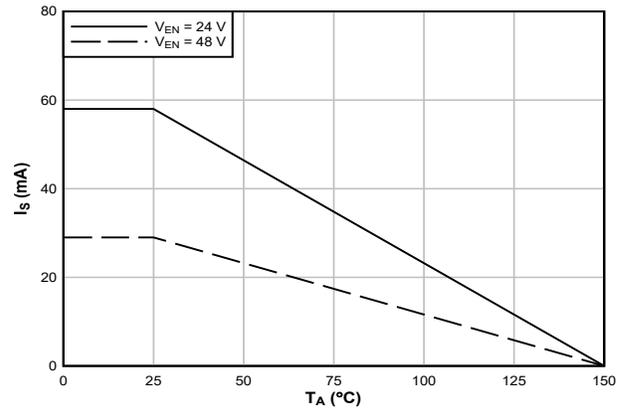
图 6-2. 根据 VDE 和 IEC 标准限制电流的热降额曲线，
