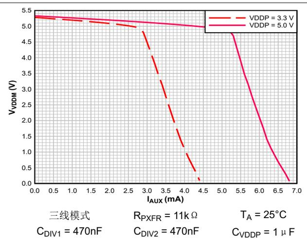
图 6-15.  $V_{VDDM}$  与  $I_{AUX}$  间的关系
