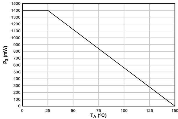
图 6-3. 根据 VDE 和 IEC 标准限制功率的热降额曲线
