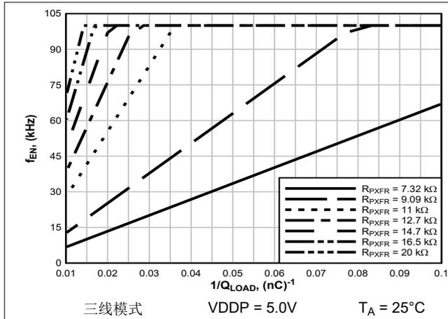
图 6-12. 最大  $f_{EN}$  与  $Q_{LOAD} = 10\text{nC}$  至  $100\text{nC}$  间的关系
