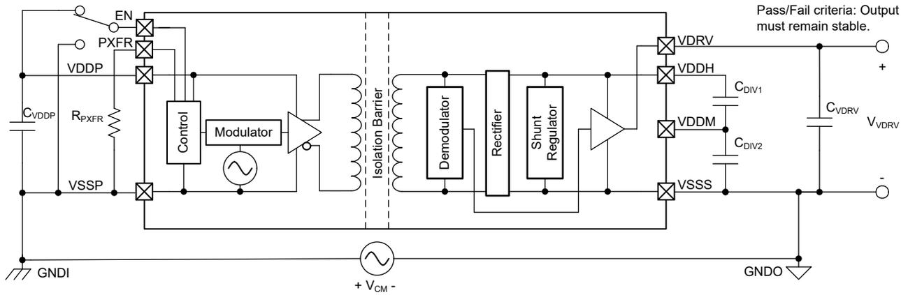
图 7-4. 共模瞬态抗扰度测试电路
