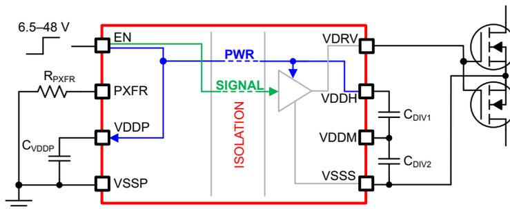
图 8-4. 两线模式简化版原理图
