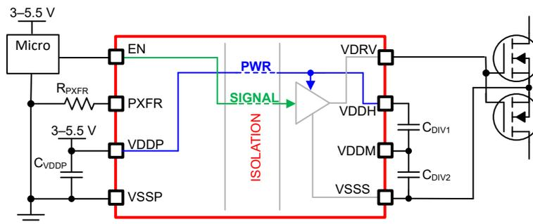
图 8-1. 三线模式简化版原理图
