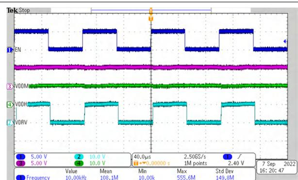
三线模式       $V_{DDP} = 5.0V$        $R_{PXFR} = 12.7k\Omega$
