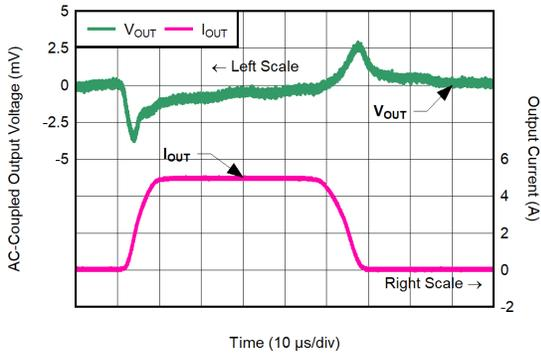
图 5-47.  $V_{OUT} = 5.2V$ 、 $I_{OUT} = 100mA$  至  $5A$ 、CP 禁用、 $SR = 1A/\mu s$ 、 $V_{BIAS} = 11V$  时的负载瞬态
