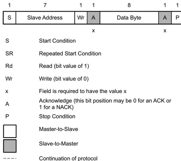
图 8-28. I<sup>2</sup>C 读/写协议键
