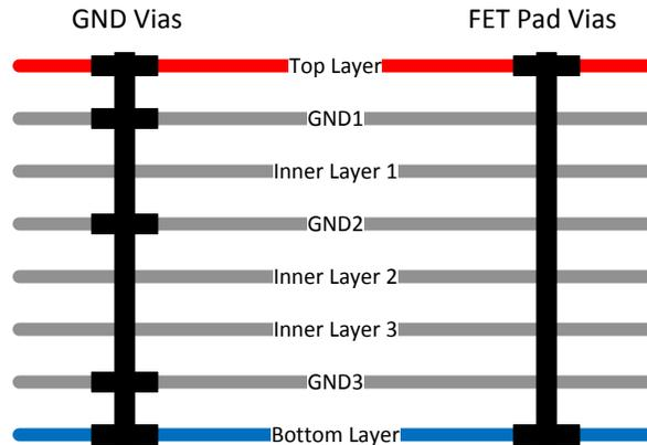
图 11-14. PCB Stack-Up
