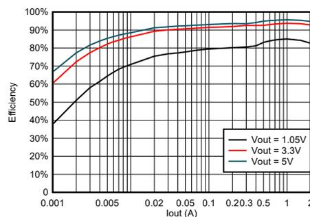
TPS562242 在  $V_{IN} = 12V$  时的效率
